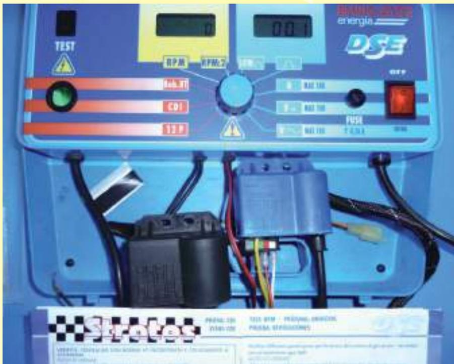
Per quanto riguarda il controllo della bobina esterna (centralina), **Stratos®**, dispone dei tester originali forniti da **DUCATI® energia** ma, basta un comune simulatore commerciale.
